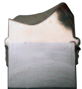
Querschnitt des elektronenstrahlschweißten Zahnkranzes und Grundkörper, zur Veranschaulichung der Verbindung des Bronzekranzes mit dem gusseisernen Grundkörper. Diese leistungsstarke Verbindung ermöglicht Kraftübertragungen unter Stoßbelastungen.
